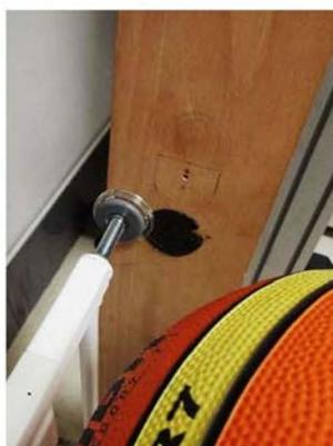
Barrière de sécurité fixée sans vis n'ayant pas tenue en place suite aux impacts répétés d'une balle dans un laboratoire d'essais
