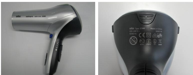
2. Eteindre et débrancher le sèche-cheveux, puis retirer le filtre de protection situé à l’arrière du sèche-cheveux.
