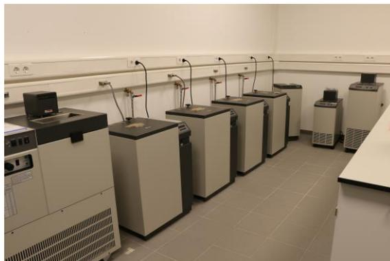
Etalons primaires du laboratoire de thermométrie – Cellules points fixes de  $-189,3442^{\circ}\text{C}$  à  $+660,323^{\circ}\text{C}$
