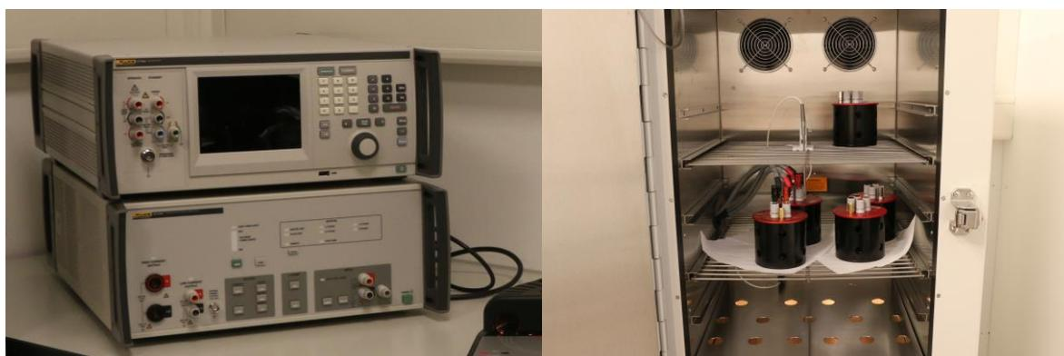
A gauche : Multi-étalonneur de Grandeurs électriques – A droite : Résistances étalons dans l'enceinte thermostatique.
