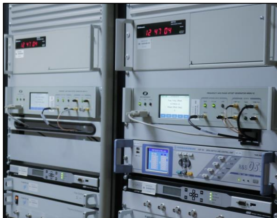
Photo: Échelle de temps nationale UTC(LUX) équipée de deux horloges à jet de Césium 133
